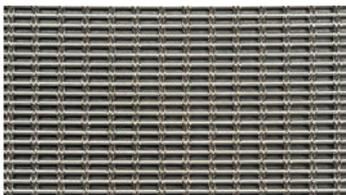
重量：4.7kg / m<sup>2</sup> 開口率37.3% 細いステンレス線とステンレスロープを細密に編み、優雅な印象を与えます。
