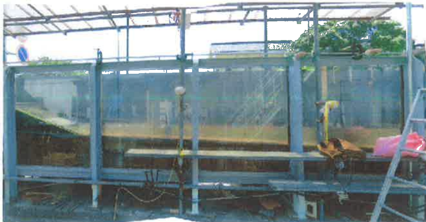
写真1 東海大学海洋学部臨海実験所の2次元造波水路
